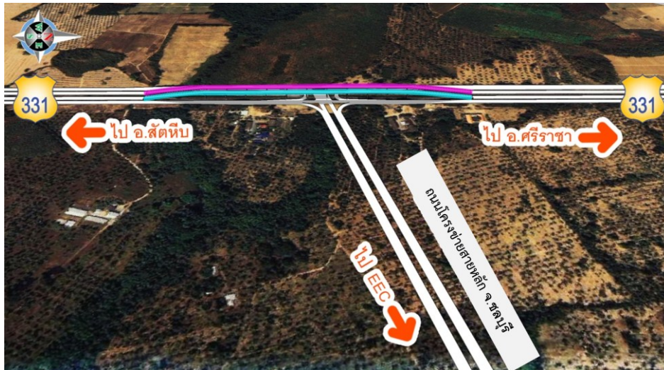
รูปที่ 8.2.1-2 รูปแบบทางแยกต่างระดับจุดตัด ทล.331 รูปแบบที่ 2 Overpass
