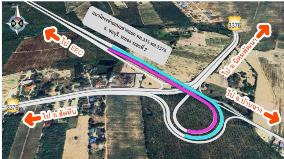
รูปที่ 7.2.3-4 รูปแบบทางแยกต่างระดับบริเวณจุดตัด ทล.3376 รูปแบบที่ 4 Trumpet
