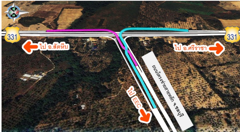
รูปที่ 8.2.1-3 รูปแบบทางแยกต่างระดับ จุดตัด ทล.331
