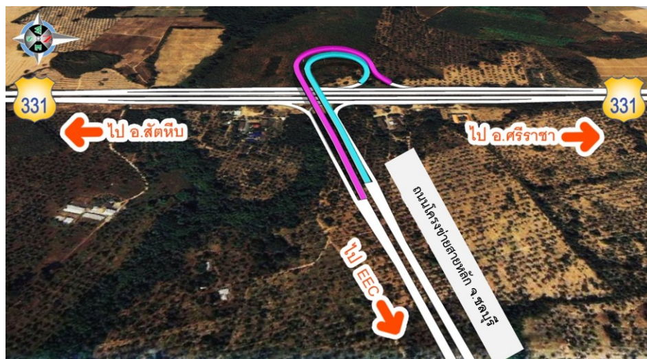
รูปที่ 8.2.1-4 รูปแบบทางแยกต่างระดับ จุดตัด ทล.331
